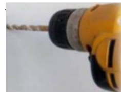
Na vyznačených miestach vyvŕtajte otvory a vložte priložené montážne kolíky s háčikmi.
